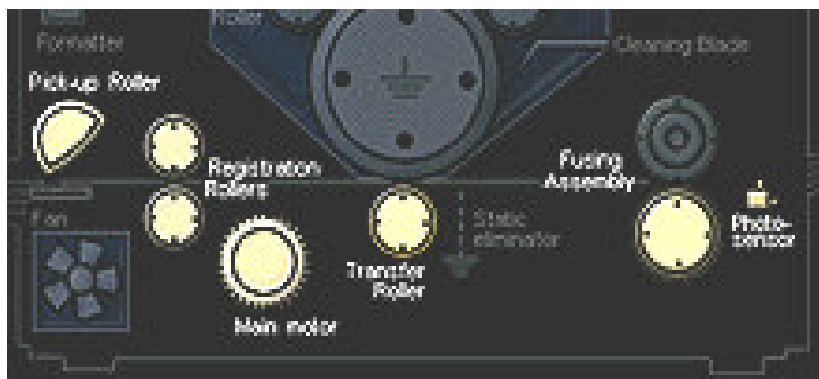
Slika 63 Elementi za transport papira kroz štampač
